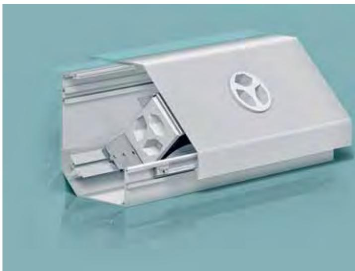
Les systèmes canal de plinthe BRECO sont disponibles en différentes dimensions et configurations. Les rails de support pour appareils aux normes DIN et les supports pour câble font partie de l'équipement de base. Les surfaces visibles sont disponibles anodisées, incolores et mattes ou revêtues à la poudre. Beaucoup de nos systèmes canal sont disponibles avec inserts visibles ou couverts.
